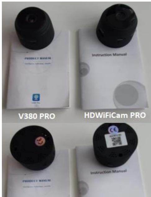
Existem dois modelos da câmara SENSORI. As câmaras diferem apenas na aplicação utilizada. Descubra qual é a sua câmara de acordo com as instruções e se a câmara possui um código QR na parte inferior.
